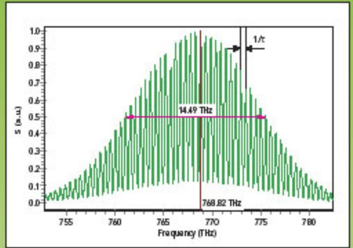
脉冲在非线性晶体内重新汇合后在光谱仪上生成一个“SPIDER图”。
